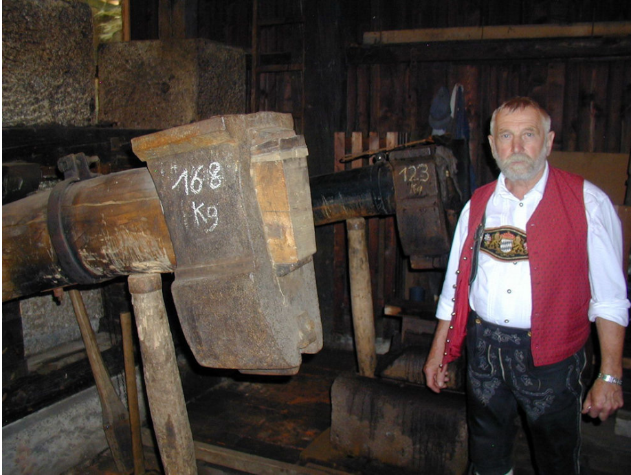
Gewaltige Hämmer bewegt das Wasserrad des Voithenberghammers zum Schmieden.
